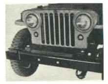
FIG. 37 — FRONT BUMPER WEIGHT
